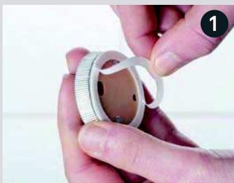
**1** Die Haftflächen müssen tragfähig, sauber, trocken, fett- und trennmittelfrei sein. Fläche mit einem trockenen, sauberen Tuch fest abreiben. Schutzfilm abziehen, **nie wieder bohren.-**Adapter positionieren und einige Sekunden lang fest andrücken.
