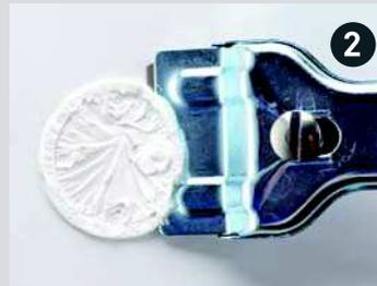
**2** Haftmittlrückstände mit einem Glasschaber entfernen.
