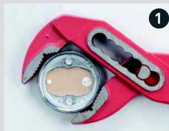
**1** Rohrzanze ansetzen und den Adapter ganz langsam mit gleichmäßigem Druck abdrehen.
