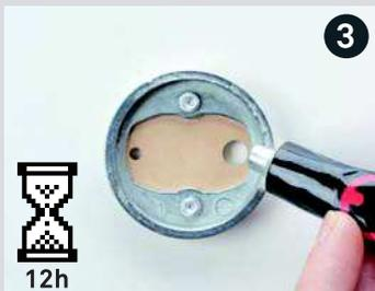
**3** Tubenspitze fest in das größere (ggf. gleich große) Loch stecken. Tubenende aufrollen und Haftmittel langsam einfüllen, bis es an der zweiten Öffnung sichtbar austritt. Erst dann ist die Klebstoffkammer komplett gefüllt. Bitte nicht nachdrücken. Mindestens 12 Stunden aushärten lassen.
